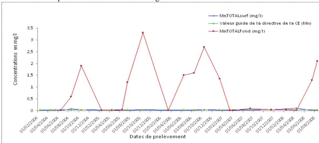
Figure 9: Variations de la concentration du Mn dans l'eau du barrage Smir en surface et au fond.
