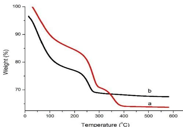
Fig 5 Thermogravimetric analysis (TGA) a) TiO<sub>2</sub>OH-Ibuprofen (1:8:8) b) TiO<sub>2</sub>OH-Ref. (1:8:8).
