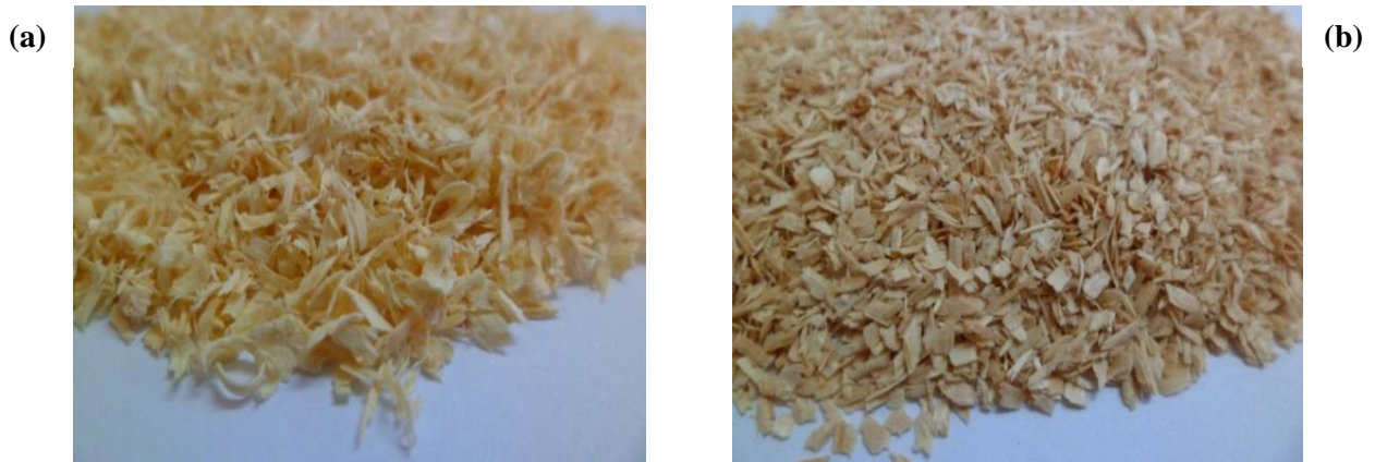
Figure 1 : Morphologie superficielle de la sciure de bois « Pinus sylvestris » non traitée (a) et traitée chimiquement (b)
