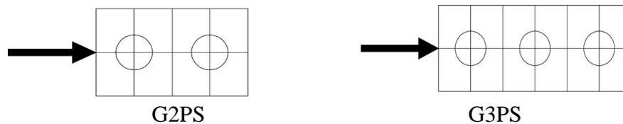
**Figure 2 :** Représentation du groupe de pieux G2PS et G3PS par le modèle de Chore [3]
