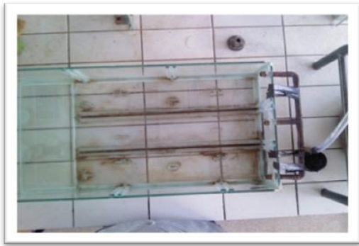
Photo 1 : Décanteur sans lamelle
