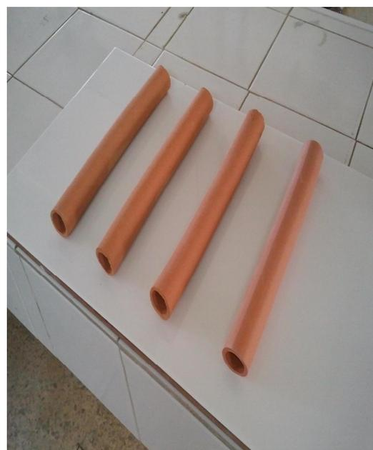
**Figure 2** : Supports tubulaires poreux de 15 % (p/p) en poudre de bois (S15) après frittage à 1000 °C/3h
