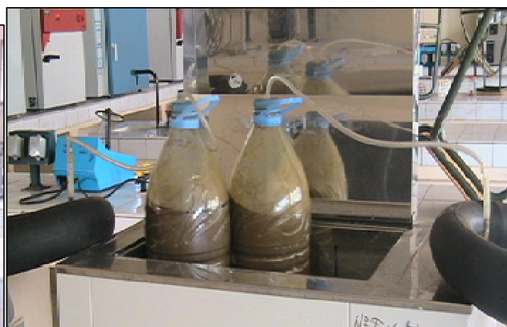
Photo 2. Production du biogaz par fermentation du mélange (V seule à droite et V+P à gauche) pendant 100 h avec agitation continue et à 41°C.
