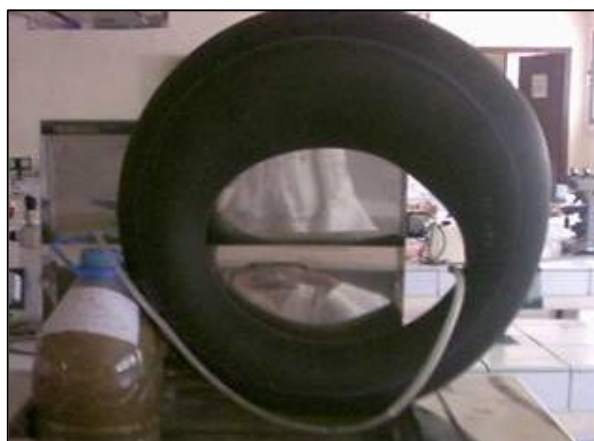
Photo 1. Production rapide du biogaz par fermentation du mélange (V +L+ P) pendant 100 h avec agitation continue et à 41°C.
