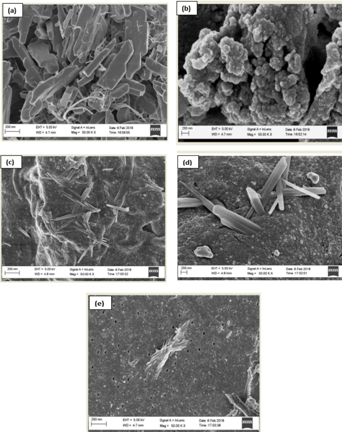
**Plate I:** HRSEM micrographs of (a) chitosan, (b) silver nanoparticles (c) COMP1:1, (d) COMP 1:2, (e) COMP 2:1
