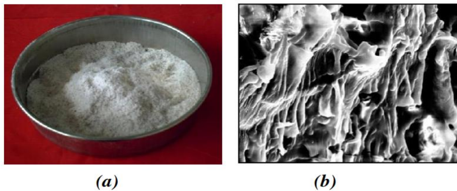
Figure 2 : a. Photo optique des particules de PET, (x10); b. Photo MEB des particules de PET, (x1100).
