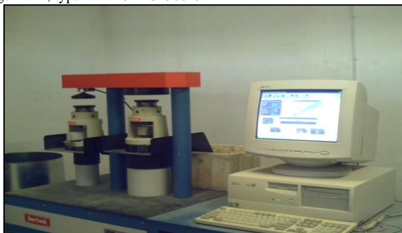
Figure 4 : Appareil IBERTEST pour les essais de flexion et de compression (LAB-MAT. ENPO)
