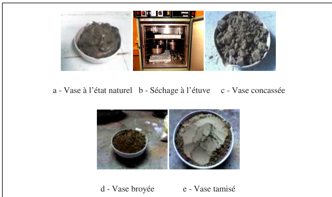
Figure 3 : Le processus de préparation de la vase draguée
