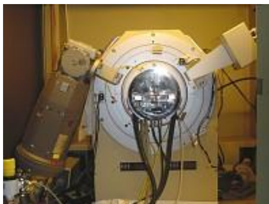
Figure 2 : Diffractomètre aux rayons X de type SIEMENS D500.
